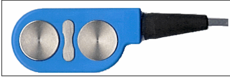
شكل (٨،٤) أقطاب سطحية لتسجيل إشارة تخطيط العضلات EMG
